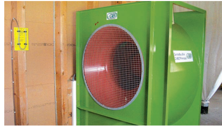
19 Fan on a hay box (Gerätebau Birk factory image)
